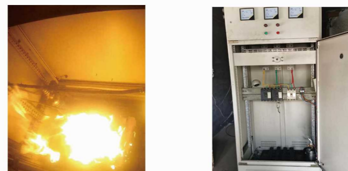
电气柜(舱)式全氟己酮灭火装置模拟火灾灭火试验现场照片
